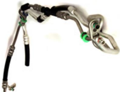
Линии для рулевого управления с усилителем (PAS) обеспечивают настраиваемое ощущение рулевого управления в сочетании с первоклассной акустической характеристикой. При применении пластиковых быстроразъемных соединителей или коррозионно-стойких соединителей ожидаемые протечки равны нулю.
